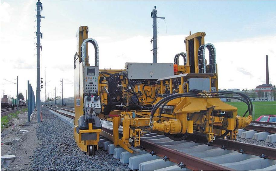
Mit diesem eindrucksvollen Fahrzeug werden die neuen Gleise für die Koralmbahn verlegt.
